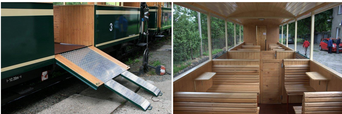
Od lewej strony: Platforma uchylna oraz wnętrze wagonu do transportu osób na wózkach inwalidzkich
